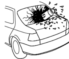
5. Nostiprināts, nepareizi novietots balons
